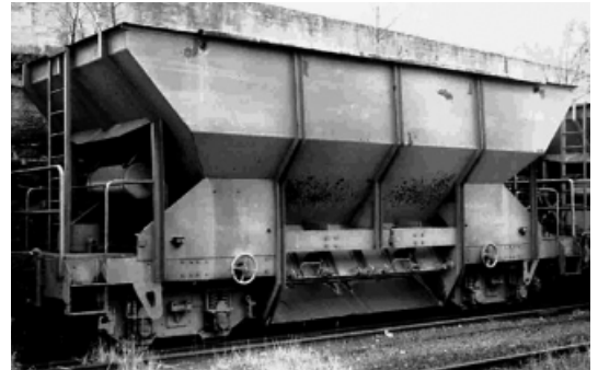
Wagen 502 wurde umgebaut mit Klappdeckeln und Schraubenfederung (Foto: P. Middelhauve)
