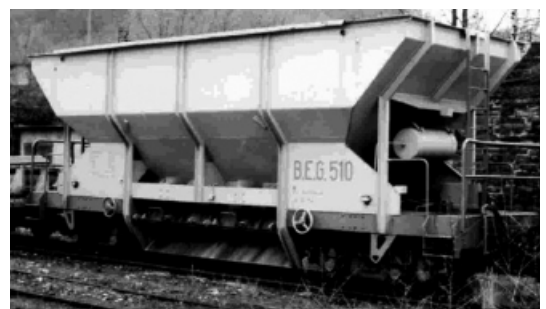
Wagen 510 soll zum Schotterwaggon umgebaut werden (für d. Gleisbau) (Foto: P.Middelhauve)
